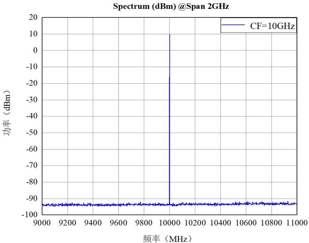
图 2 10GHz 中心频率上的远端杂散
