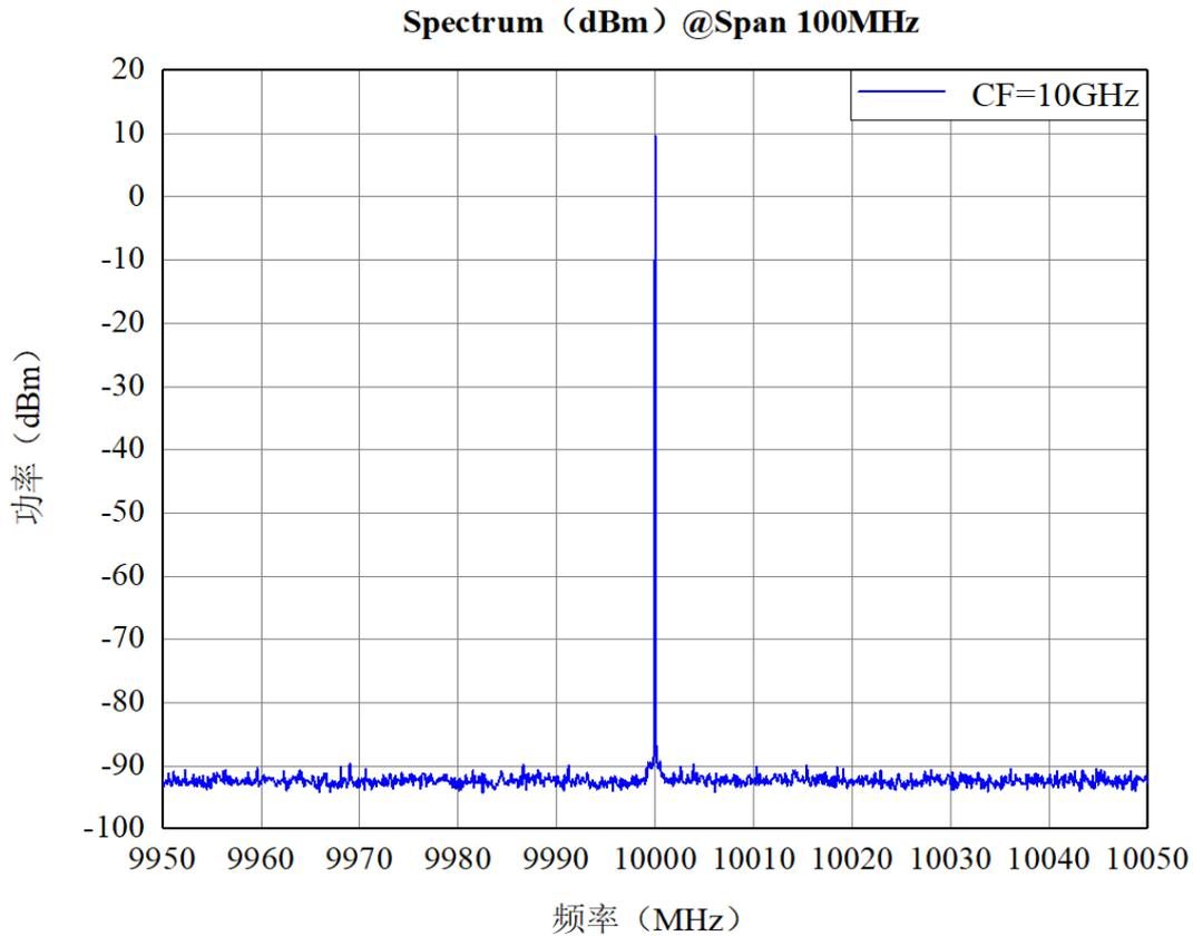
图 1 10GHz 中心频率上的近端杂散
