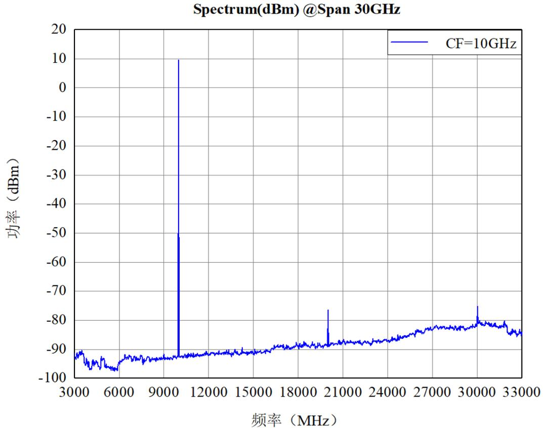
图 3 10GHz 中心频率上的谐波抑制
