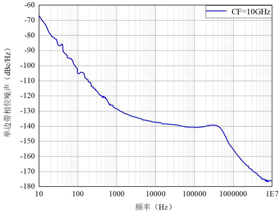
图 4 10GHz 中心频率上的标称相位噪声
