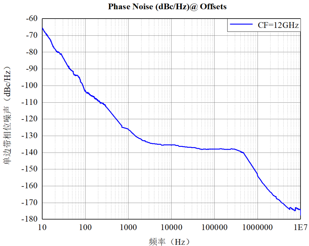
图 4 12GHz 中心频率上的标称相位噪声
